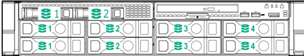
8x 3.5 型ドライブモデル (SAS/SATA HDD) + 2x2.5 (SAS/SATA HDD/SSD, PCIe SSD)
