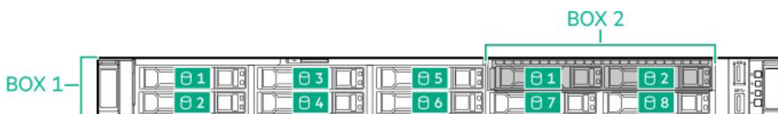
8x 2.5 型ドライブモデル（SAS/SATA/NVMe HDD/SSD） + 2x 2.5 型（SAS/SATA/NVMe HDD/SSD）
